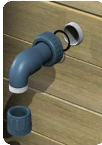
► Umwickeln Sie die Gewinde der Bögen der starren abfallenden Rohre C (Einlaufdüse) 4 bis 5 mal mit Klebeband. Schrauben Sie die Rohre dann an die Außenseite der Wanddurchführungen (Einlaufdüse und Reinigeranschluss). Vergessen Sie dabei die O-Ringe aus dem Einbauteile-Set nicht. Ziehen Sie die Schrauben von Hand an, um die Dichtung nicht zu beschädigen.
