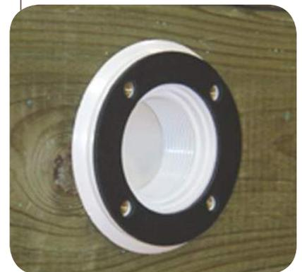
▶ Von der Innenseite des Pools her bauen Sie nun die Wanddurchführungen für die Einlaufdüsen (Einbauteile-Set) in die vorgebohrten Öffnungen ein. Befestigen Sie sie mit Hilfe der Holzschrauben (VB FZ) 3x25.
